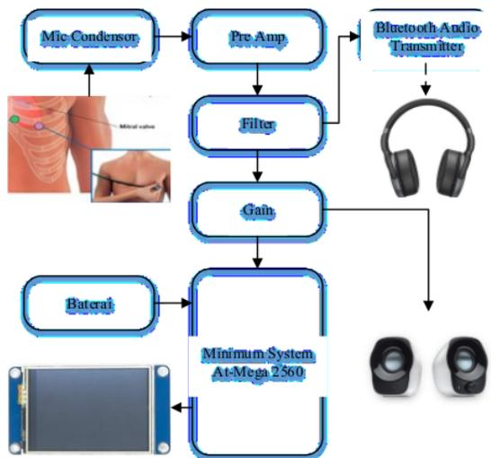
Gambar 1. Diagram Blok Stetoskop Elektronik Portabel
